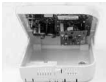
Étape 5: Remontez le couvercle sur le sélecteur.
