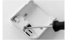
Étape 3: Ouvrez le clapet sur la plaque de base pour que les connecteurs électriques soient visibles.
