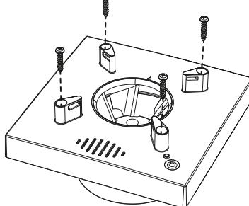
**3. Montez Waves dans l'ouverture du mur**
