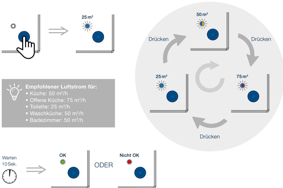
Eine zweifarbige LED bedeutet, dass die LED abwechselnd in zwei verschiedenen Farben blinkt (in diesem Fall blau, violett, blau, violett usw.)
